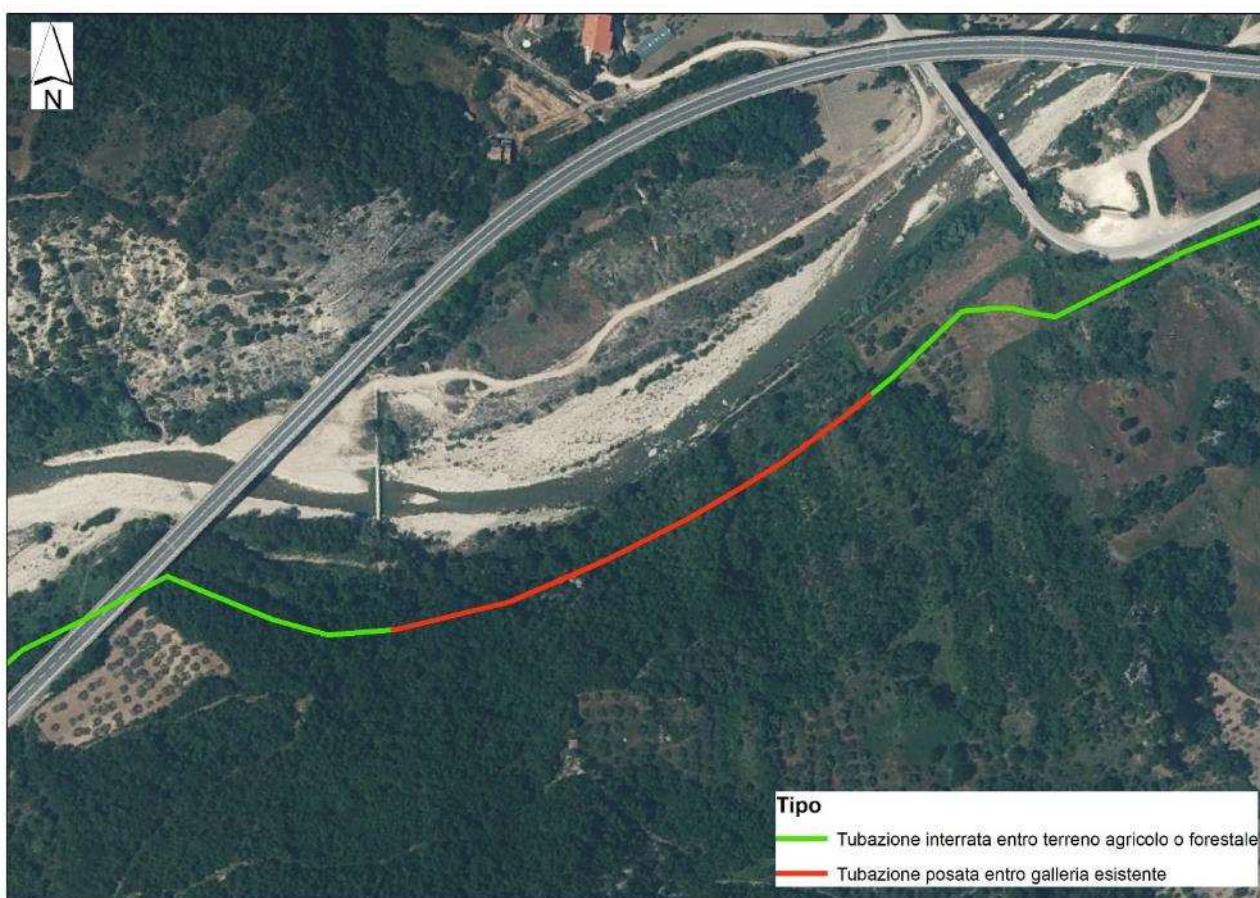
Porzione della condotta in area boscata, dove solo il tratto iniziale comporta trasformazione di bosco, in quanto la parte terminale ricalcherà l'esistente galleria.
